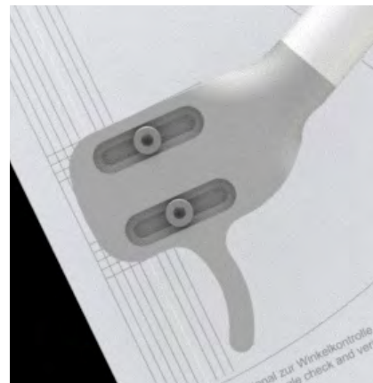
Abb. 2: Ausrichtung des Tonabnehmers
