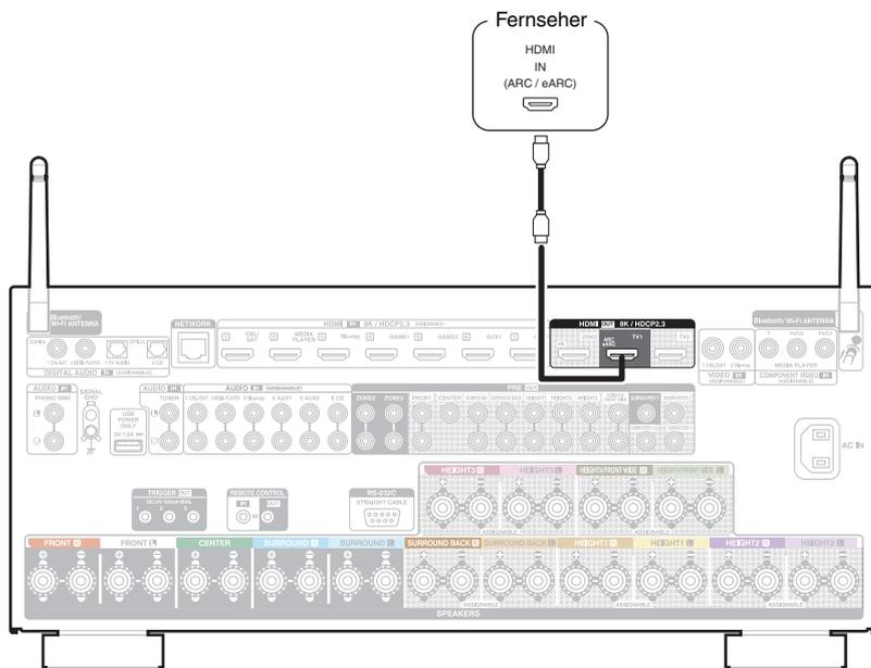
\* Für 4K-Fernseher empfehlen wir die Verwendung eines HDMI-Kabels mit der Kennzeichnung "High Speed" und "mit Ethernet".
