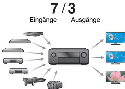
Zum Anschluss an eine breite Auswahl digitaler Quellen verfügt dieses Gerät über 7 HDMI-Eingänge, die es Ihnen ermöglichen, schnell und bequem einen Camcorder, eine Spielekonsole oder ein anderes mit HDMI ausgestattetes Gerät anzuschließen. Es gibt zwei HDMI-Ausgänge für den Hauptraum und einen dritten HDMI-Ausgang für ZONE2.
