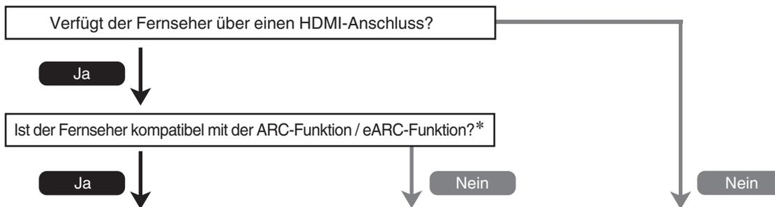
**“Anschlussweise 1: Der Fernseher verfügt über einen HDMI-Anschluss und ist kompatibel mit ARC / eARC”** (☞ S. 74)
