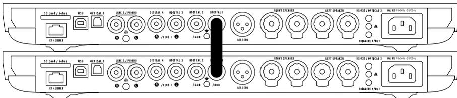
システムをデュアルモノモードに設定するには、各スピーカーを各機器に接続し、両方のスピーカーをデジタルケーブル (S/PDIF または S/PDIF-AES/EBU) で接続させてください。Companionの方の入力端子をご使用になりたい場合は、二台の機器も同様に、Masterのイン/アウトリガコネクタからCompanionのRS232コネクタにアナログ式のステレオミニジャックケーブルを使って接続してください。
