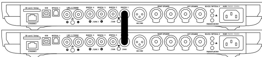
Pour configurer votre système en mode Dual-Mono, branchez chaque enceinte sur un appareil et reliez les par un câble digital (S/PDIF ou S/PDIF-AES/EBU).
