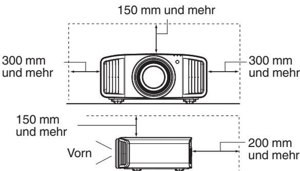
Blockieren Sie nicht die Vorderseite des Geräts. Wenn sich blockierende Gegenstände vor der Luftauslassöffnung befinden, wird heiße Luft in das Gerät zurückgesaugt und es erhitzt. Heiße Luft, die aus dem Gerät ausströmt, kann auf der Leinwand Schatten verursachen (Hitzeblimmern).
