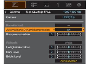
**3** Konfigurieren der Grundhelligkeit in „Kompressionsstufe“
