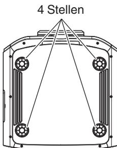
Nehmen Sie die vier Füße von der Geräteunterseite ab und befestigen Sie das Gerät mithilfe der Schrauben (M5-Schrauben, 15 bis 25 mm).
