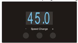
Der Antriebsriemen muss sich auf der Riemenscheibe des Motor-Pulleys mit dem kleinen Durchmesser befinden. **Speed Change** startet den Antriebsmotor und schaltet zwischen den Geschwindigkeiten 33 und 45 U/Min um. Die angewählte Geschwindigkeit wird digital angezeigt.
