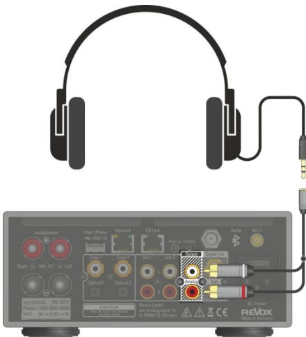
Anschluss über Adapter „Cinch-Klinkenkupplung“, z.B. Cordial CFY 0,3 YCC
