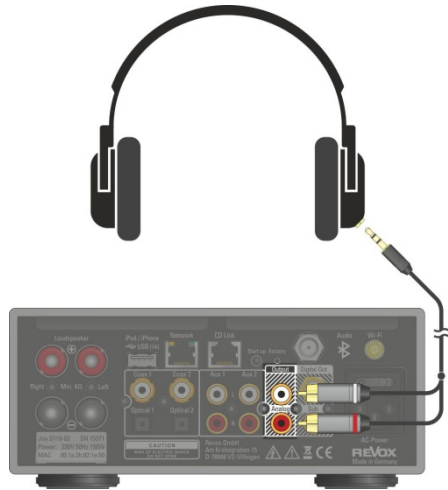
Direkter Anschluss über Adapter „Cinch-Klinken-Stecker“, z.B. Cordial CFY 3 WCC .
