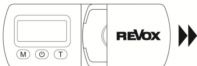
Abb.: Schutzhaube von Tonarmwaage abziehen
