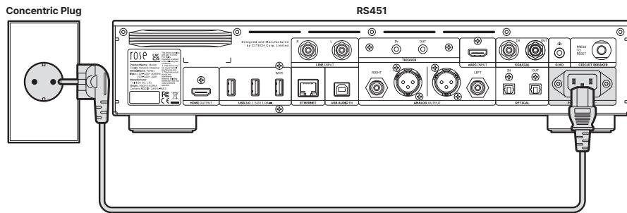
**⚠ Achtung:** Beim Trennen des Stromkabels immer zuerst die Steckdose trennen, während der Netzschalter ausgeschaltet ist.
