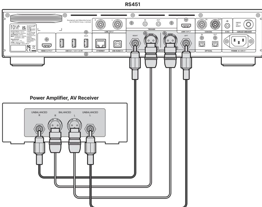
**Achtung:** Bevor Sie dieses Produkt mit dem Verstärker verbinden, stellen Sie die Lautstärke auf stumm oder unter Level 5 und schließen Sie es dann mit einem Verbindungskabel an. Andernfalls kann beim Anschließen bei hoher Lautstärke ein lautes Knallgeräusch auftreten.
