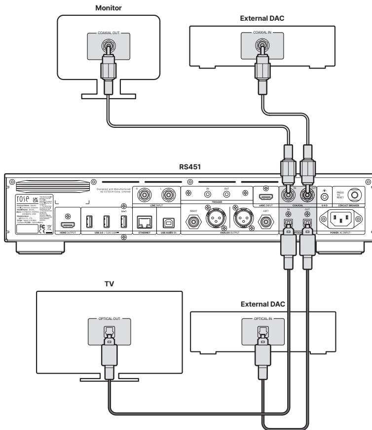
**⚠ Achtung:** Geben Sie keine anderen Signale als lineare PCM-Signale, wie Dolby Digital, DTS und AAC, an dieses Gerät ein. Dies kann Rauschen verursachen und die Lautsprecher beschädigen.
