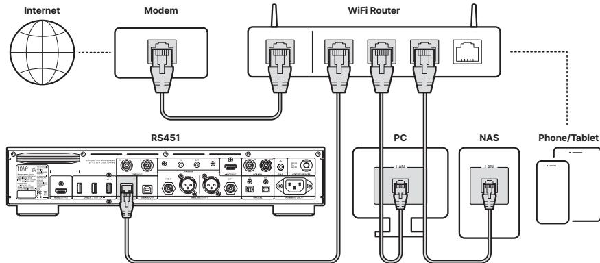
※ Um dieses Produkt auf Ihrem Smartphone (ROSE Connect Premium) zu steuern, muss es mit demselben Netzwerk verbunden sein. (Ein einheitliches Netzwerk kann mit WLAN-Extendern, Bridges usw. konfiguriert werden.)
