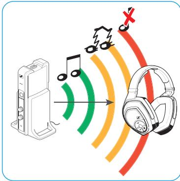
Die Reichweite des Senders hängt von Umgebungsbedingungen ab, wie z. B. der Dicke und Zusammensetzung von Wänden. Wenn Sie mit dem Kopfhörer die Reichweite des Senders verlassen, fällt der Ton zunächst gelegentlich aus, bevor die Verbindung endgültig abbricht.
