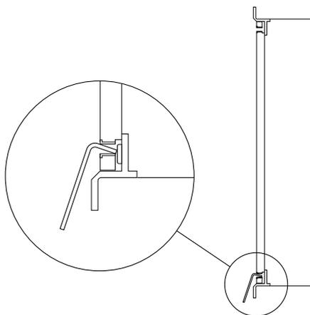
Usare un qualsiasi attrezzo, ad esempio una chiave a brugola come in figura, per fare delicatamente leva e sfilare il pannello in legno.
