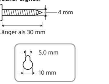
Bohrung an der Rückseite des hinteren Lautsprechers
