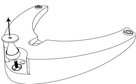
2.2 Glisser le câble dans l'orifice prévu sur le socle comme représenté ci-dessous :
