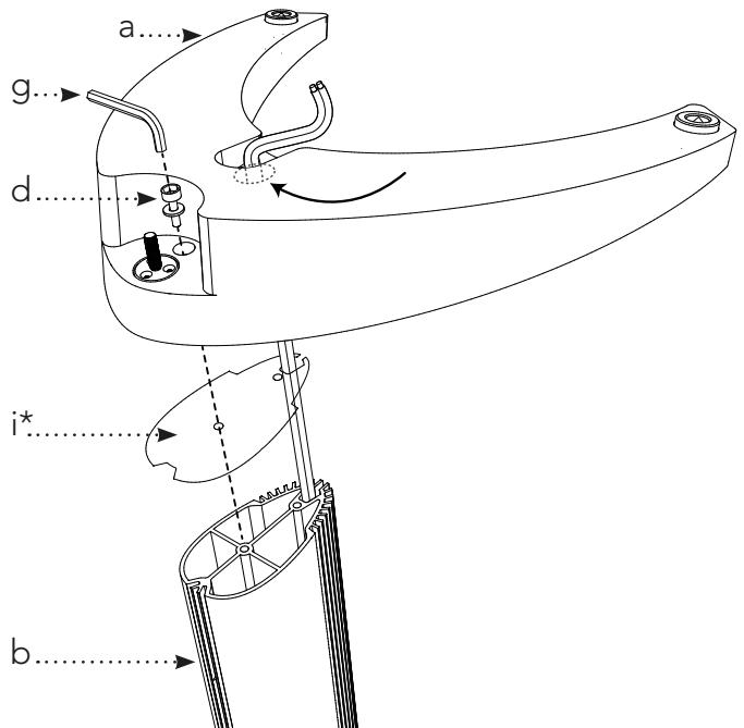
**\*NOTE :** Intercaler la feuille de protection (i.) entre le socle (a.) et le tube aluminium (b.). Puis assembler les 2 parties grâce à la vis (d.) et la clé (g.) fournies.
