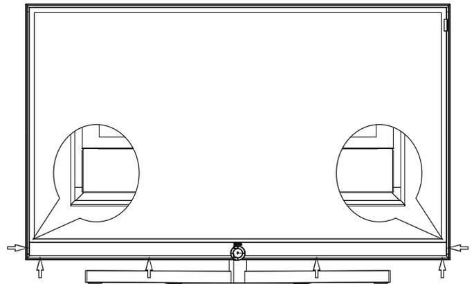
Schrauben Sie auf der Geräterückseite die beiden inneren Befestigungsschrauben (A) M4x20 / TX20 und die beiden äußeren Schrauben (B) M4x18 / TX20 an den gekennzeichneten Stellen ein. Drehen Sie diese handfest an.
