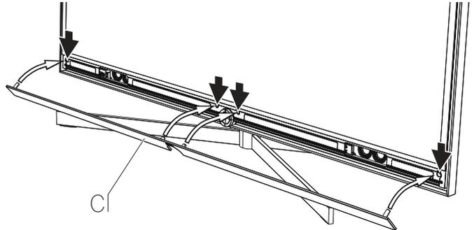
Die Frontblende wird durch Magnete gehalten. Schieben Sie die Frontblende nach oben, bis diese mit der Frontscheibe bündig abschließt. Achten Sie auf die gleichmäßige seitliche Ausrichtung (Zentrierung).
