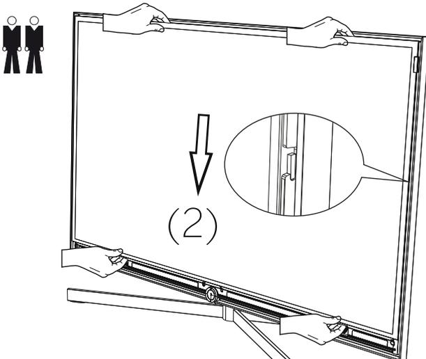
Nehmen Sie die Frontblende (C) und führen Sie die beiden mittleren Befestigungsbolzen in die beiden Aussparungen. Anschließend werden die beiden Seiten der Frontblende von der Mitte aus nach außen angedrückt. Führen Sie die beiden äußeren Befestigungsbolzen in die beiden Aussparungen.
