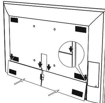
Zum Anbringen der Kabelabdeckungen setzen Sie die Oberkante der Kabelabdeckung am Gerät an und drücken die Führungen in die Profile der Geräterückwand bis die Abdeckung am Gerät einrastet.
