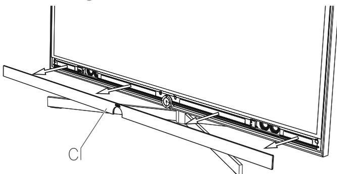
Die Scheibe kann nun abgenommen werden. Dies sollte unbedingt durch zwei Personen erfolgen. Greifen Sie an der Unterseite der Frontscheibe in die beiden Aussparungen. Achten Sie dabei darauf, dass Sie die dahinterliegenden Lautsprecher nicht beschädigen. Fassen Sie die Scheibe zusätzlich an der Oberkante an.
