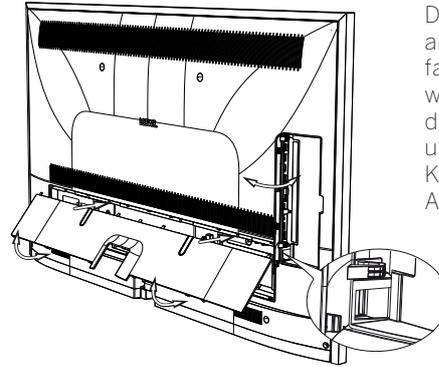
Die seitliche Abdeckung am TV-Gerät kann ebenfalls ganz abgenommen werden. Hierzu öffnen Sie diese bis zum Anschlag und ziehen mit geringer Kraft an der geöffneten Abdeckung.
