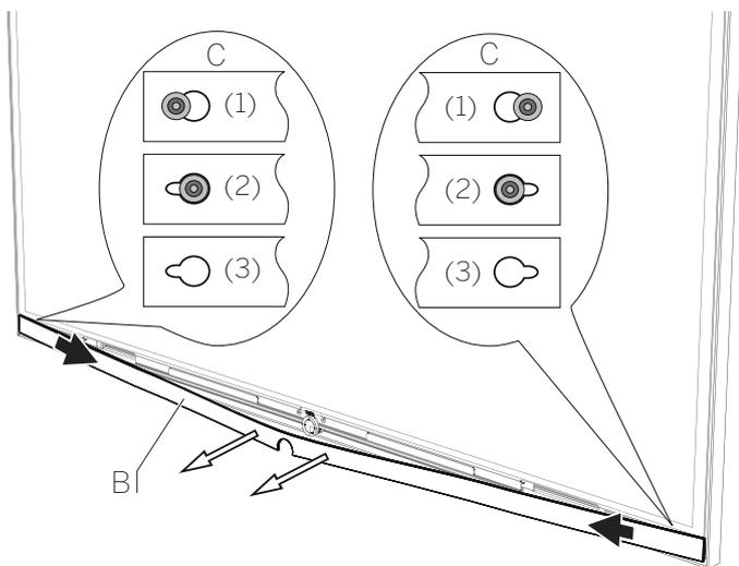
C (1) Frontblende (B) am TV-Gerät, Bajonettverschlüsse (C) verriegelt
