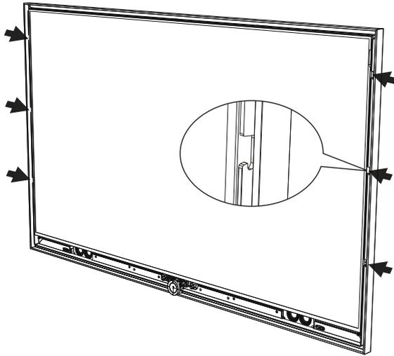
Positionieren Sie die Scheibe mittig über dem Panel des TV-Gerätes. Achten Sie darauf, dass Sie das Panel und das umlaufende Aluminiumprofil am TV-Gerät nicht beschädigen. Führen Sie die Scheibe in die Befestigungspunkte ein (1) und schieben Sie die Scheibe langsam in die Verriegelung nach unten (2). Wenn das Spaltmaß seitlich und oben gleich ist, wurde die Scheibe richtig montiert.
