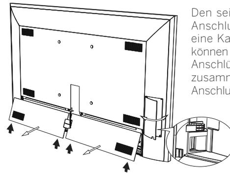
Den seitlichen und hinteren Anschlussbereich verbindet eine Kabeldurchführung. So können Sie Kabel der seitliche Anschlüsse durchführen und zusammen mit den hinteren Anschlusskabeln verlegen.
