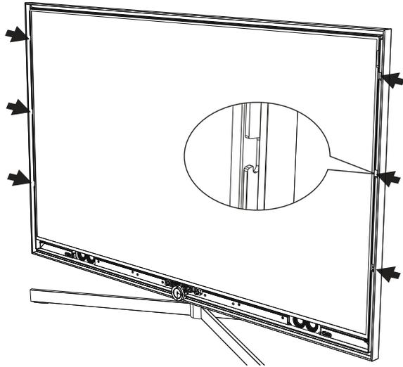
Positionieren Sie die Scheibe mittig über dem Panel des TV-Gerätes. Achten Sie darauf, dass Sie das Panel und das umlaufende Aluminiumprofil am TV-Gerät nicht beschädigen. Führen Sie die Scheibe in die Befestigungspunkte ein (1) und schieben Sie die Scheibe langsam in die Verriegelung nach unten (2).
