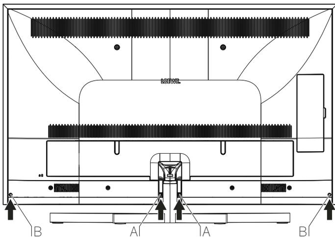
**i** Bei Verwendung der Aufstelloption Wandhalter WM67 müssen Sie die Unterseite des TV-Gerätes vorsichtig von der Wand wegziehen oder von der Wand nehmen, um mit dem passenden Werkzeug die vier Schrauben an der Geräterückseite zu entfernen. Achten Sie dabei darauf, dass Sie TV-Gerät und die dahinterliegende Wand mit dem Werkzeug nicht beschädigen. Die weitere Demontage der Scheibe erfolgt von der Gerätevorderseite.
