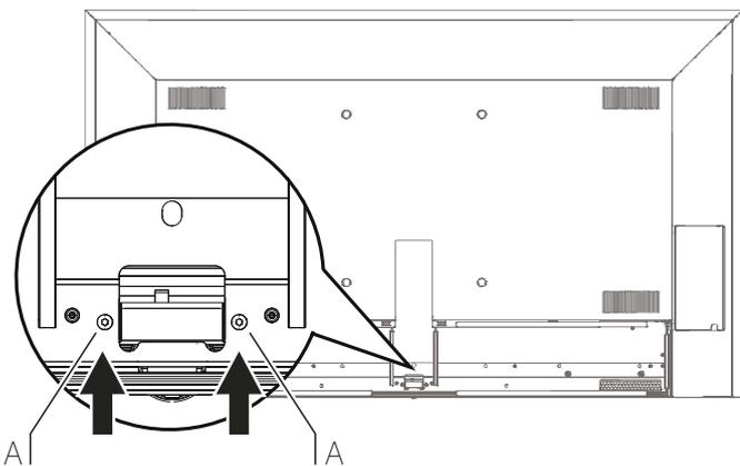
Bei Verwendung der Aufstelloption Wandhalter (Wall Mount Reference 75/85) müssen Sie mit einem passenden Winkelschlüssel TX20 die beiden Schrauben an der Geräterückseite entfernen. Achten Sie dabei darauf, dass Sie TV-Gerät und die dahinterliegende Wand mit dem Werkzeug nicht beschädigen. Die weitere Demontage der Scheibe erfolgt von der Gerätevorderseite.
