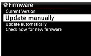
① Besorgen Sie sich zunächst die neue Firmware-Datei und speichern Sie diese im Hauptverzeichnis eines USB-Sticks oder direkt auf der Festplatte des X14.
