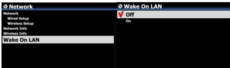
Wenn "Wake On LAN" aktiviert ist, kann der X14 durch ein Signal von außen via Netzwerk eingeschaltet werden.
