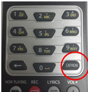
Durch Drücken der CAP/NUM-Taste auf der Fernbedienung können Sie zwischen den beiden Modi 'Springe zu Prozent' und 'Springe zu Song' umschalten.
