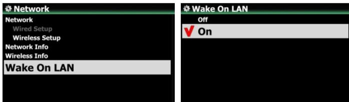
Wenn bei "Wake On LAN" AN eingestellt ist, kann der X45 durch ein Signal von außen via Netzwerk eingeschaltet werden.
