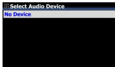
Wenn ein USB DAC oder ein HDMI-Audiogerät an den Audioausgang des X45 angeschlossen ist, werden die angeschlossenen Geräte hier angezeigt und können ausgewählt werden.
