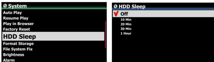
※ Der X45 benötigt ca. 3-4 Sekunden, um aus dem Ruhemodus zu "erwachen". Während dieser Zeit spricht der X45 mit Verzögerung auf Befehle der Fernbedienung an.
