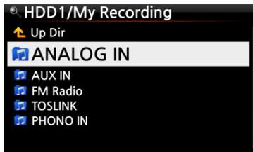
① Mit dem Cursor markieren Sie den Aufnahme-Ordner (z.B. TOSLINK, COAXIAL, etc) oder die aufgenommene Datei, die sich im Ordner befindet, und drücken die MENÜ-Taste.
