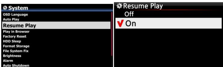
Öffnen Sie das SETUP-Menü -> System -> "Wiedergabe fortsetzen". Wählen Sie AN und bestätigen Sie mit der OK-Taste (siehe Bild)
